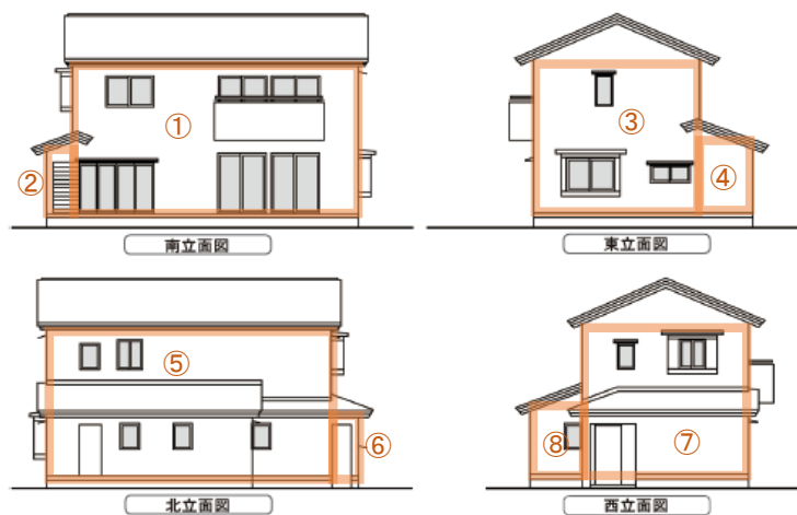
図3 立面図にマーカーを塗り求積範囲を示した例
