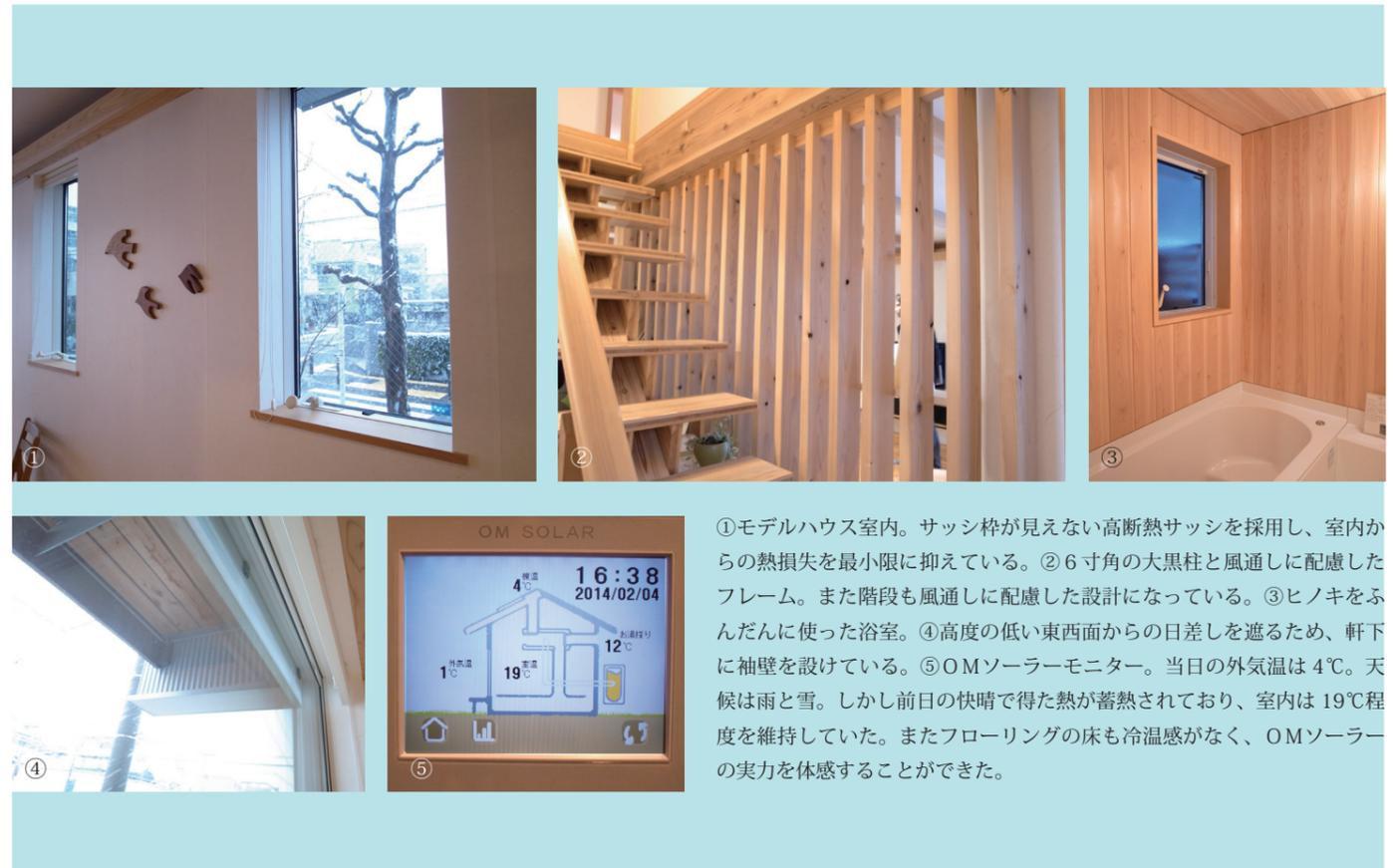
①モデルハウス室内。サッシ枠が見えない高断熱サッシを採用し、室内からの熱損失を最小限に抑えている。②6 寸角の大黒柱と風通しに配慮したフレーム。また階段も風通しに配慮した設計になっている。③ヒノキをふんだんに使った浴室。④高度の低い東西面からの日差しを遮るため、軒下に袖壁を設けている。⑤OMソーラーモニター。当日の外気温は 4℃。天候は雨と雪。しかし前日の快晴で得た熱が蓄熱されており、室内は 19℃程度を維持していた。またフローリングの床も冷温感がなく、OMソーラーの実力を体感することができた。
