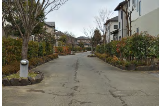
図 3-17 6m 道路の街並み。この道路に沿って各コモンの入り口が設けられている。舗装はセンター排水のためV字型。
