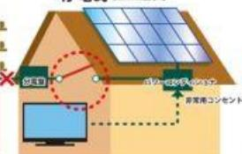
図 1-6 太陽光発電システムの自立運転利用
