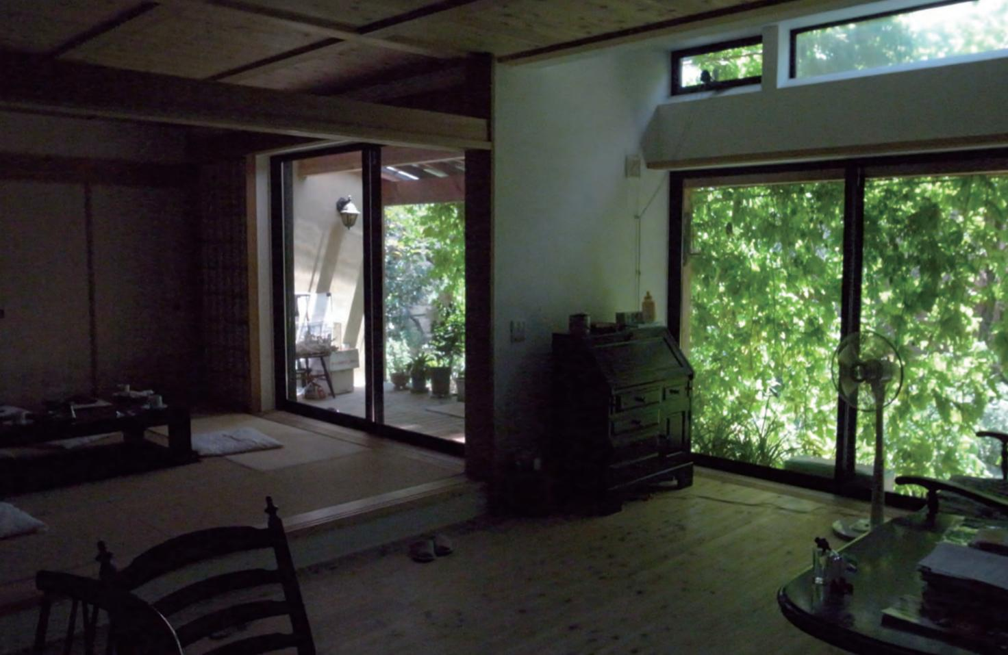
壁はすべて漆喰。天井と床は天然木（1階室内）。洋間は高窓採光、和室は後退窓で縁側付きにと、冬季の採光を考えた工夫が。
