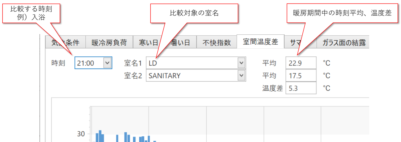
グラフビューワーに新たに追加された室間温度差タブ上で、比較する時刻、比較対象の室名を選択
